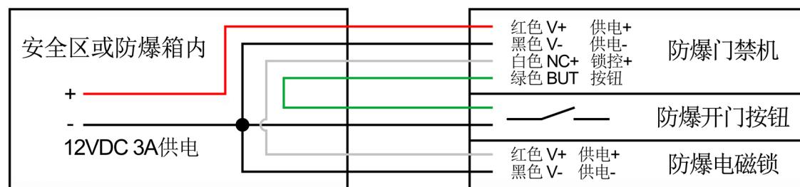
安装注意事项：本防爆门禁机自带4米延长线，延长线如需对接再延长，线缆接头必须使用防爆接线盒。
